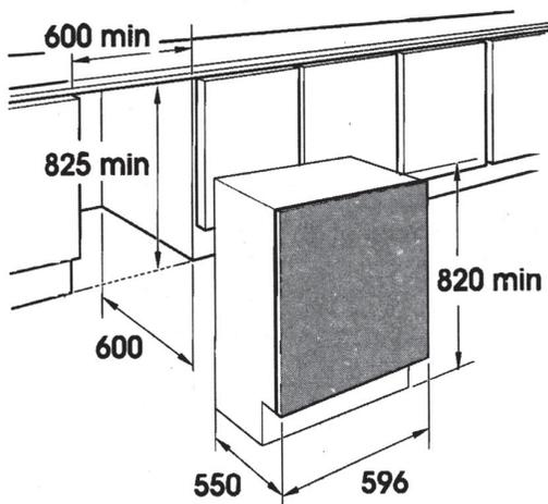
Le 4 pattes réglables permettent de varier la hauteur de la machine à laver en passant de 820 mm (enlever les écrous et les remplacer par des écrous de 5 mm) à 840 mm maxi. En haussant les pattes ne pas oublier de bloquer les contreécrous sur le fond en tôle
